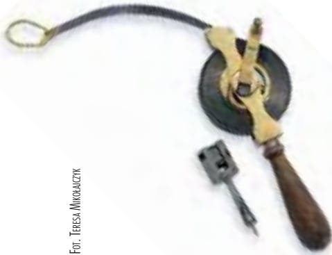
Ruletka z pierwszej połowy XX wieku i węgielnica z lat 70.
