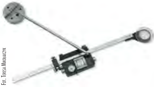
Planimetr, jedno z niewielu urządzeń geodezyjnych produkcji polskiej
