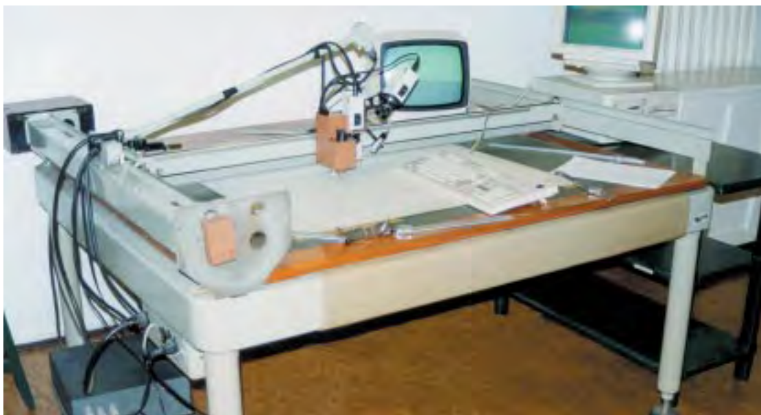
Na stronie obok fragment numerycznie opracowanej topograficznej mapy Legionowa w skali 1:10 000, 1999 Poniżej stół kartujący – koordynatograf Zeissa sprzężony z komputerem i kamerą wideo, 1994
